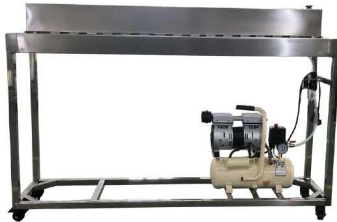
Flekso Klise Punch Makinesi (Her delik için ayrı hava silindiri ile)
